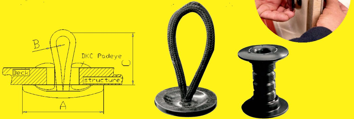
TyTec® CDK Padeyes werden ausschließlich unterhalb der Struktur verwendet. Sie sind in Durchmessern von 50, 60 und 70 mm und in verschiedenen Looplängen bzw. -stärken erhältlich. Die Arbeitslasten liegen je nach Größe und Loop zwischen 1300daN und 3600daN. Sie werden immer mit der Hülse DKC verwendet, die im Lieferumfang enthalten ist.,.
